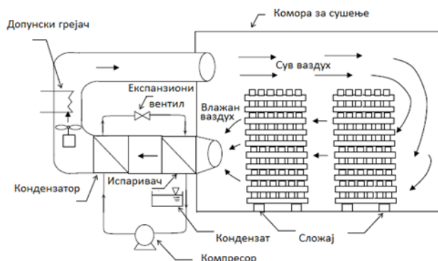
Slika 4 šematski prikaz sušare sa toplotnom pumpom [7]
